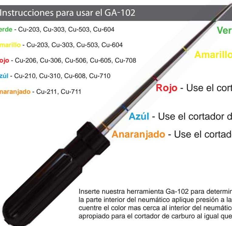
Inserte nuestra herramienta Ga-102 para determinar la profundidad y diámetro de la herida en neumáticos. Desde la parte interior del neumático aplique presión a la herramienta mientras la gira. Cuando sienta una resistencia encuentre el color mas cerca al interior del neumático. Refiera a la información aquí arriba para determinar el tamaño apropiado para el cortador de carburo al igual que el diámetro de la reparación a utilizar.
